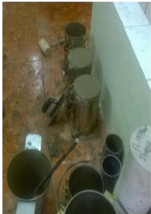
FOTO 12: Elaboración de probetas monolíticas de concreto normal f'c 210 kg/cm 2
