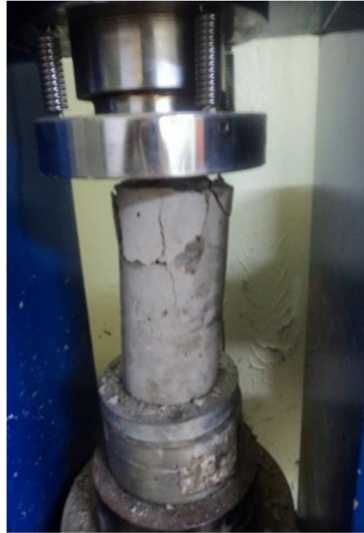
FOTO 14: Forma de falla de probetas ensayadas a compresión.
