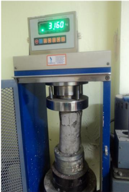
FOTO 13: Ensayos de resistencia a la compresión del concreto de probetas con/ sin tratamiento de adhesión estructural y monolíticas
