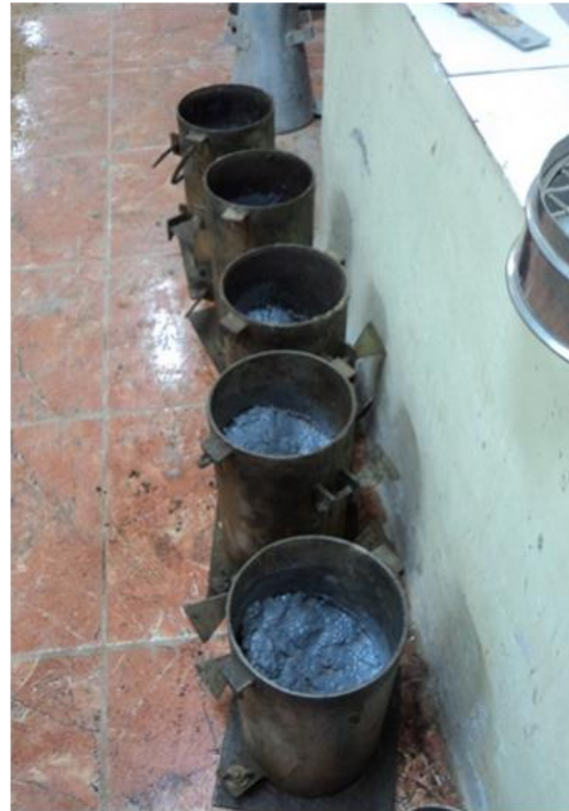
FOTO 06: Muestras con adhesivo estructural aplicado, previo al vaciado de la segunda capa de concreto.
