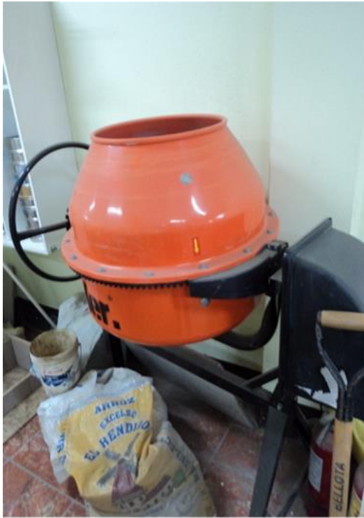
FOTO 01: Mezcla de componentes según proporciones del diseño de mezcla f'c 210 kg/cm 2
