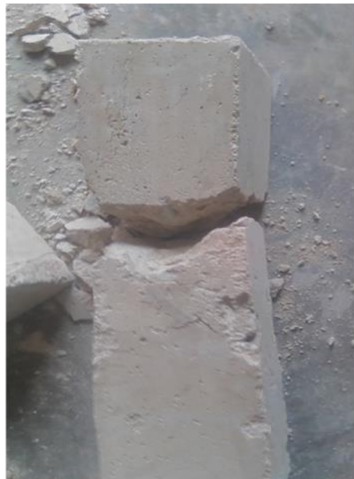
FOTO 20: Falla de testigos prismáticos luego del ensayo de resistencia a esfuerzos de flexión por carga central
