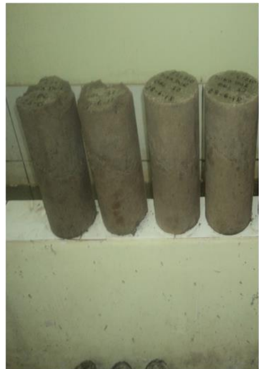
FOTO 08: Probetas desmoldadas segmentadas por junta fría con tratamiento de adhesivo estructural SIKA.
