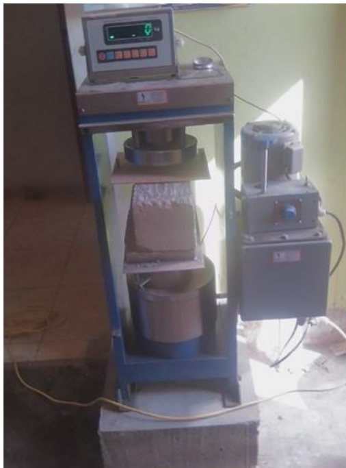
FOTO 19: Ensayos de resistencia a la flexión del concreto de testigos prismáticos con/ sin tratamiento de adhesión estructural y monolíticas
