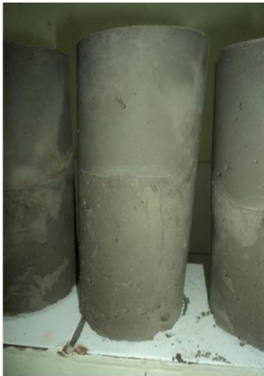
FOTO 11: Probetas desmoldadas segmentadas por junta fría sin tratamiento de adhesivo estructural.
