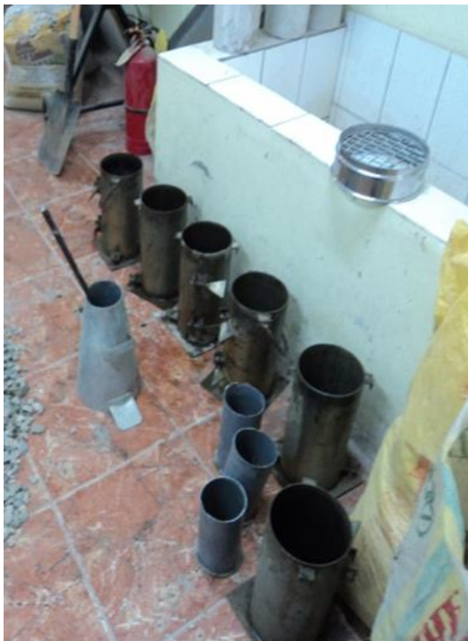
FOTO 03: Cono de arena para verificación de consistencia del concreto y moldes para elaborar probetas
