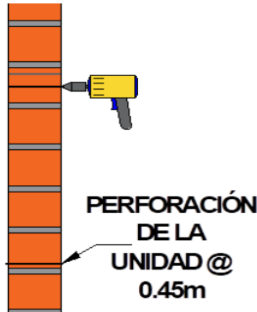
Figura 21. Perforación de la unidad del muro.
