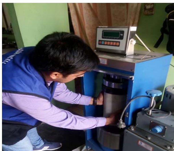
Foto 11. Colocado de testigo forma cilíndrica.
