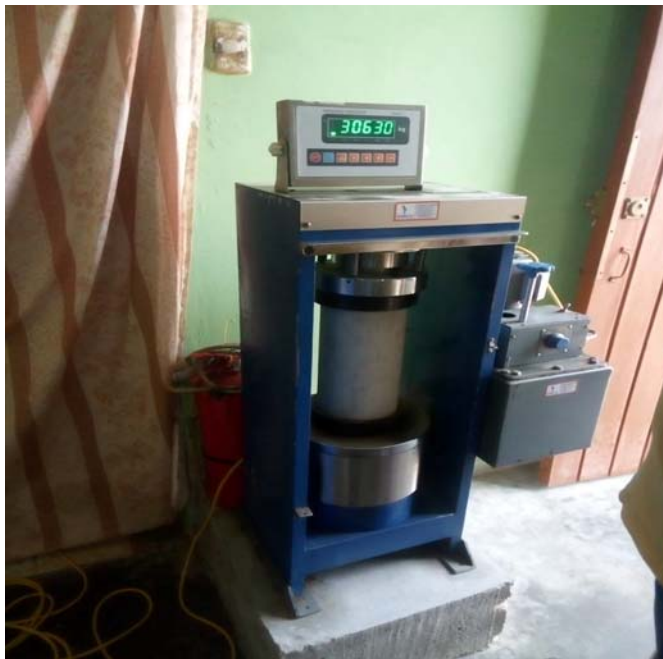
Foto 12. Rotura de testigos de concreto de forma cilíndrica
