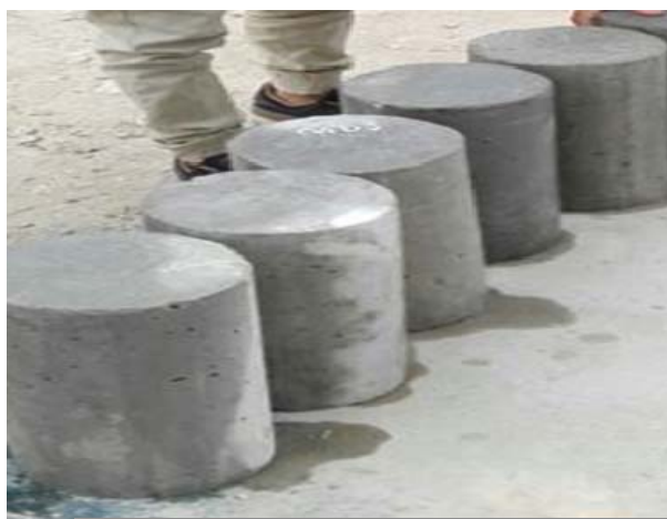
Foto 8. Testigos de concreto convencional y adicionado de forma cilíndrica
