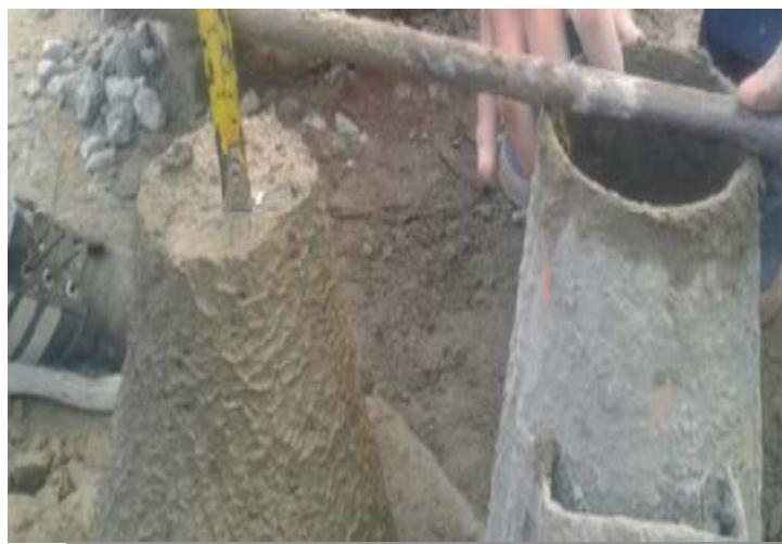
Foto 5. Evaluación de propiedades mecánicas del concreto en estado fresco
