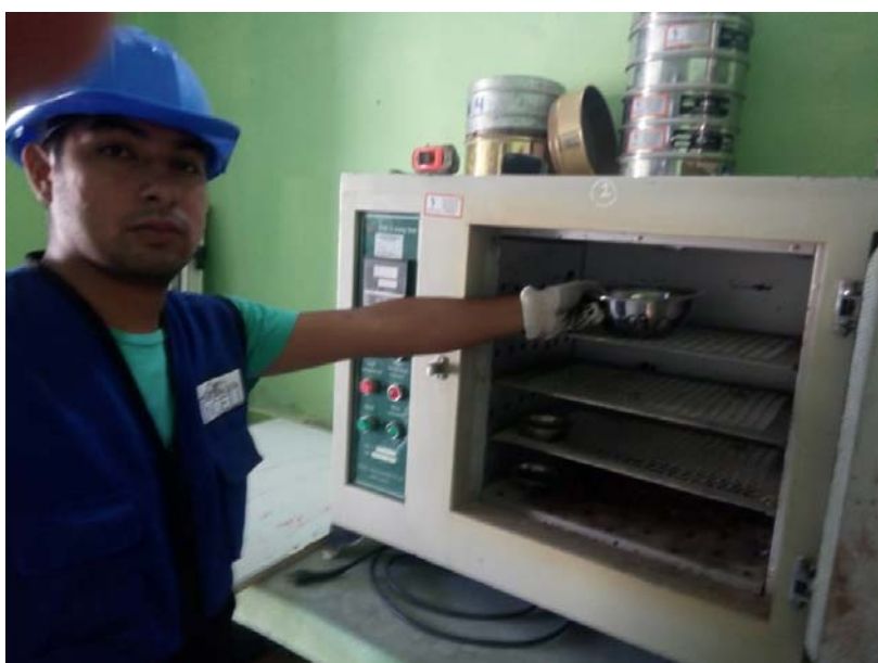
Foto 2 . Ingreso del agregado al horno a temperatura.
