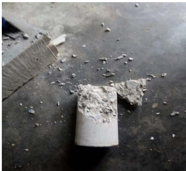
Foto 13. Resultado de rotura de testigos de concreto de forma Cilíndrica
