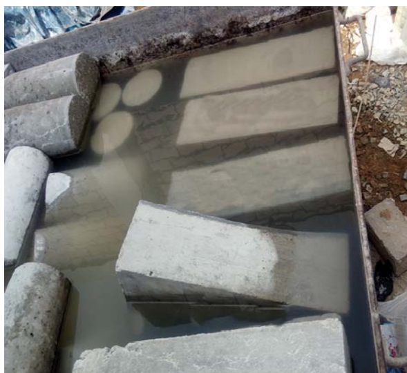
Foto 10. Curado de testigos de concreto convencional y con caucho reciclado
