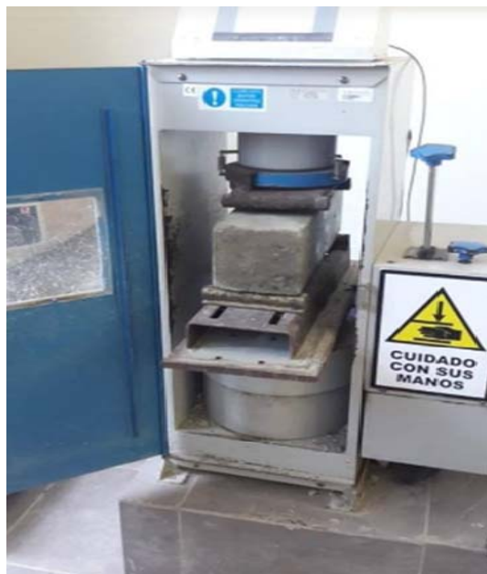
Foto 14. Rotura de testigos de concreto de forma de viga
