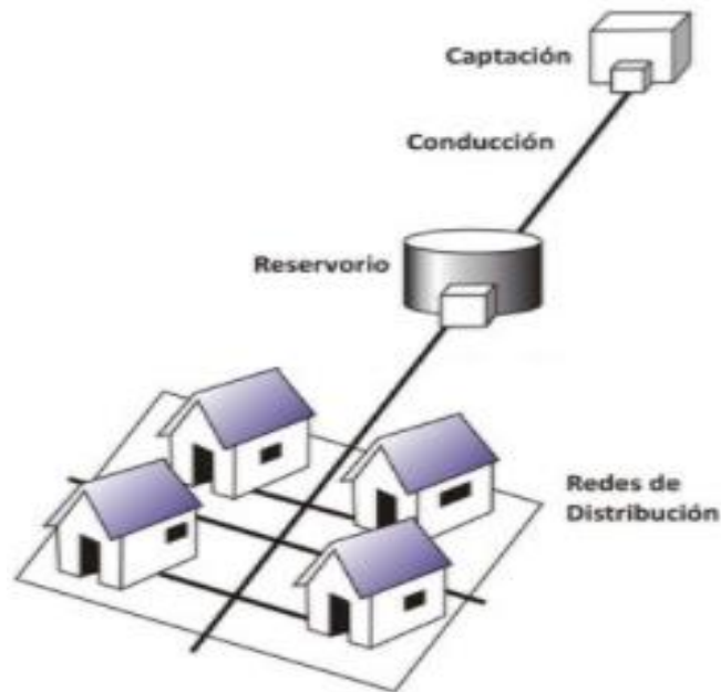
Figura 1. Sistema de agua por gravedad
