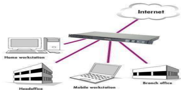
Figura 013. Conexión VPN.- En esta figura tenemos una conexión VPN (Red Privada Virtual), es una red segura que conecta a computadoras de escritorio a laptops a través de un router para así conectarse con sus sucursales y compartir recursos de modo seguro
