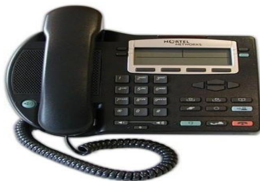
Figura 012. Teléfono IP.- En esta figura tenemos un teléfono ip, es el dispositivo que se usan para realizar las llamadas ya sean locales, nacionales en nuestra misma red ya sea con conexión VPN.
