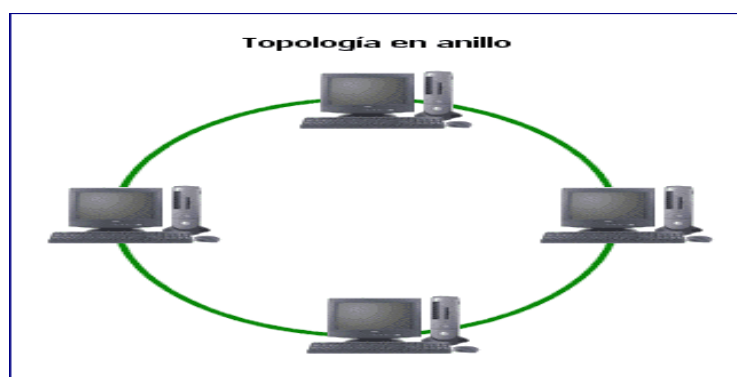
Figura 003. Topología Anillo.- En esta figura tenemos un ejemplo de la topología en anillo donde la dirección de la información es una sola, donde si el anillo se rompe la información se pierde.
