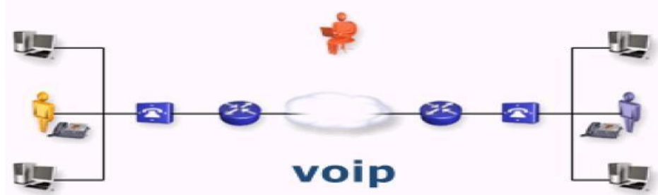
Figura 009.Telefonia VOIP.- En esta figura tenemos un ejemplo del funcionamiento de telefonía voip donde las computadoras contiene teléfonos voip virtuales y contamos con un teléfono voip real donde hacemos llamadas a través de internet hacia el otro local.
