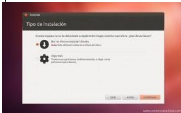
Figura 022. Interfaz tipo de instalación.- El siguiente paso es indicar la zona horaria para después seleccionar el tipo de teclado que utilizas, puede ser Español o Latinoamericano, es muy fácil identificarlo pues el símbolo \ en el teclado Español está a la izquierda a un lado del “1”
