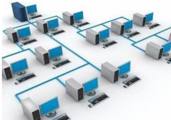
Figura 001. Red LAN.- En esta figura tenemos un ejemplo de una red LAN (Área Local) de topología estrella, administrado por un servidor para la compartición de recursos y servicios.
