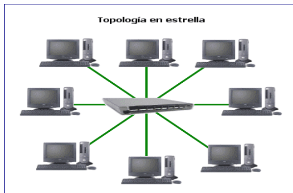
Figura 004. Topología Estrella.- Es esta figura tenemos un ejemplo de la topología estrella la más usada en toda empresa ya que es más organizada y están conectados a través de un hub la que se encarga a pasar toda la información que circula en la red.
