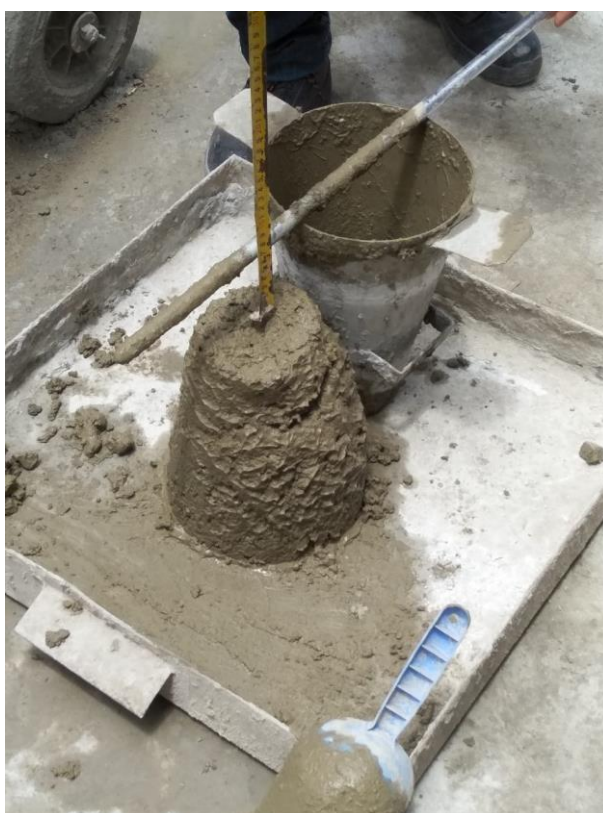
Foto 4. Evaluación de propiedades mecánicas del concreto en estado fresco
