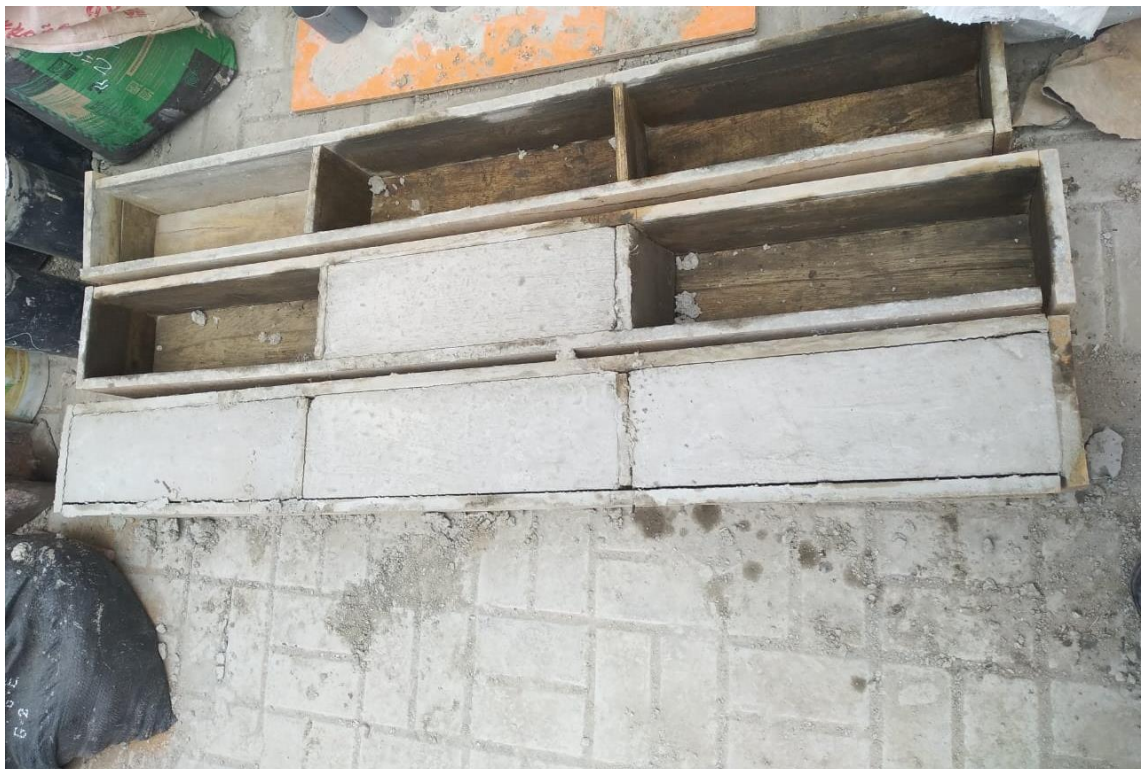
Foto 8. Testigos de concreto convencional y adicionado de forma de viga
