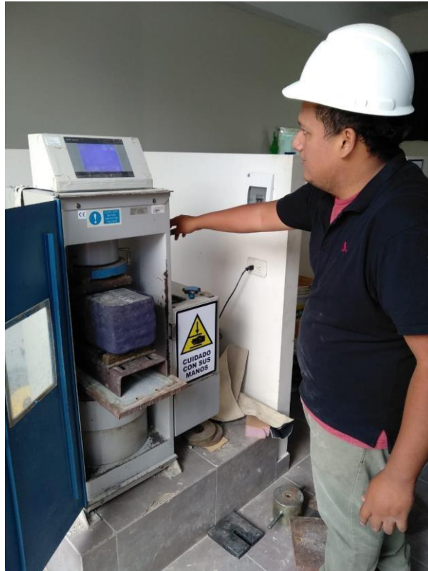
Foto 11. Rotura de testigos de concreto de forma de viga
