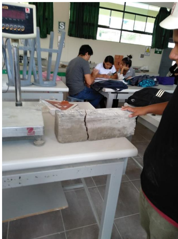
Foto 12. Resultado de rotura de testigos de concreto de forma de viga
