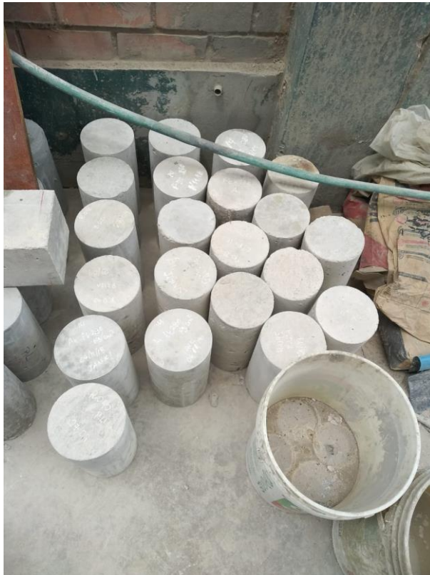
Foto 7. Testigos de concreto convencional y adicionado de forma cilíndrica
