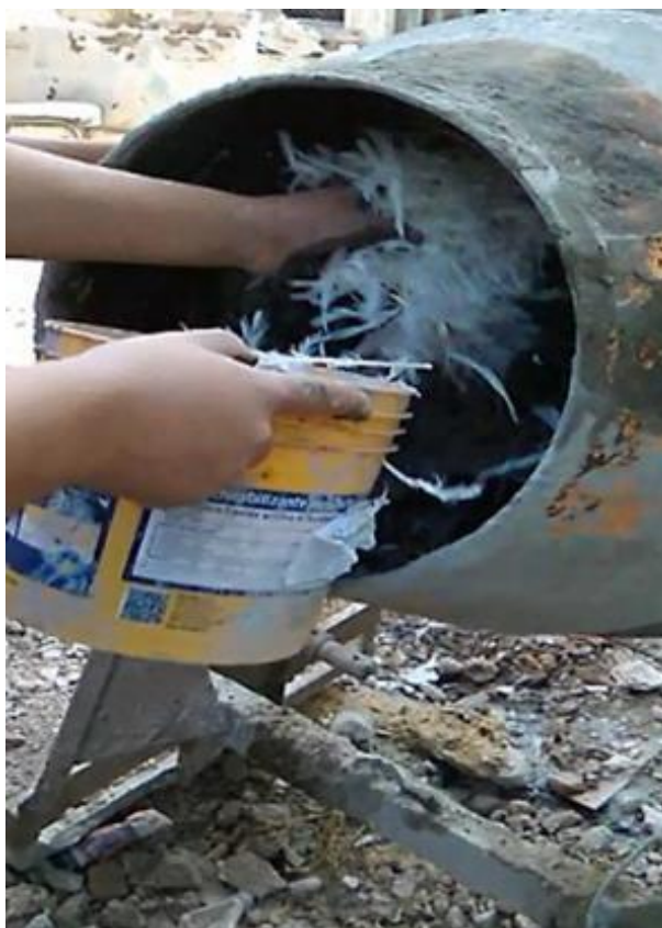
Foto 5. Diseño de mezcla de concreto convencional y adicionado con plumas de ave
