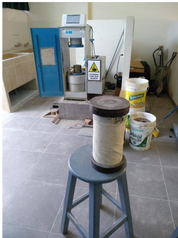
Foto 10. Rotura de testigos de concreto de forma cilíndrica
