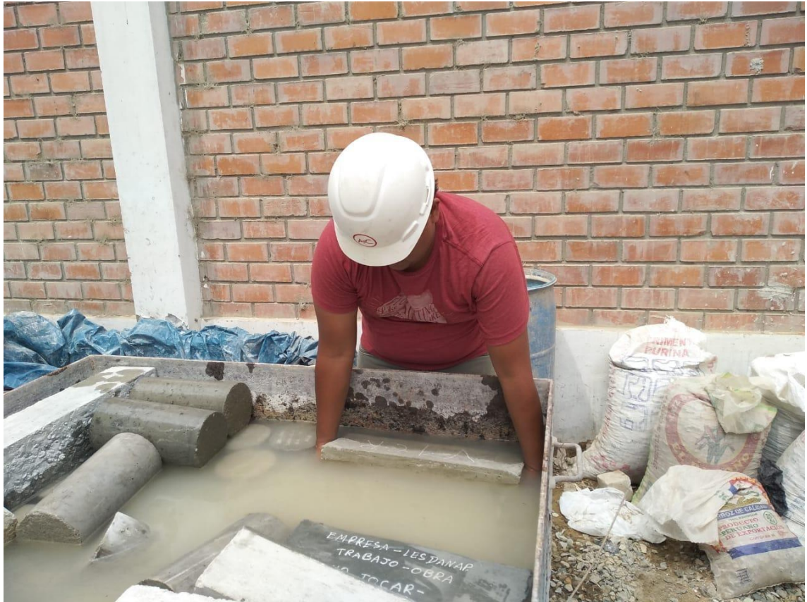
Foto 9. Curado de testigos de concreto convencional y adicionado con plumas de ave
