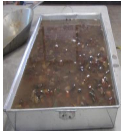
Figura 19: agregado grueso saturado por 24 horas
