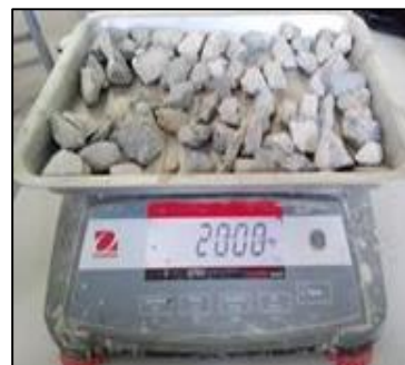
Figura 38: toma de peso de muestra de agregado grueso para determinar su humedad
