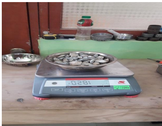
Figura 34: peso de la muestra de agregado grueso con el recipiente
