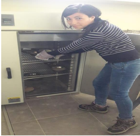
Figura 24: muestra del agregado fino tamizado por la malla n° 4 puesta en el horno para su secado
