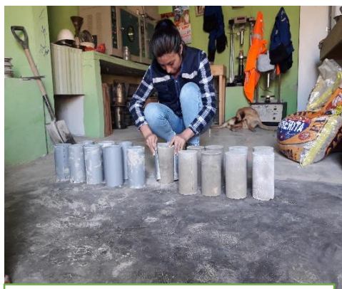
Figura 52: desmoldado de muestras de concreto a las 24 horas después de su vaciado
