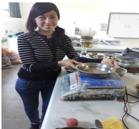
Figura 33: peso de la muestra de agregado fino con el recipiente
