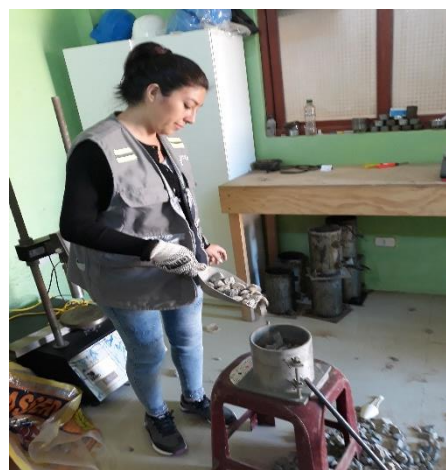
Imagen 9: llenado del molde del agregado grueso
