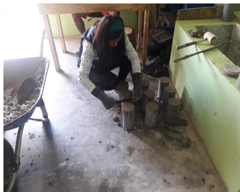
Figura 51: enrasado de muestras de concreto
