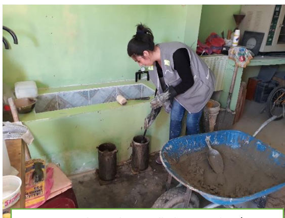
Figura 42: chuseado o varillado por cada 1/3 por tres veces
