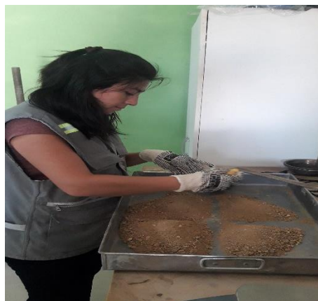
Figura 7: cuarteo del agregado fino
