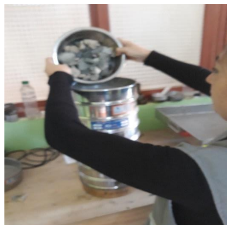
Imagen 4: serie de tamices por las que pasara el agregado grueso
