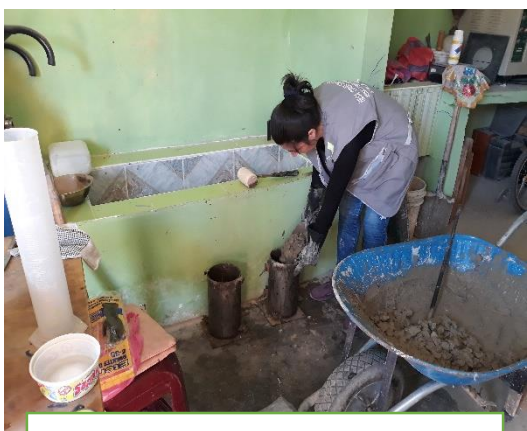
Figura 41: llenado de concreto
