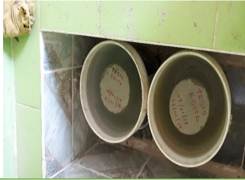
Figura 45: muestras de concreto puestas a curando
