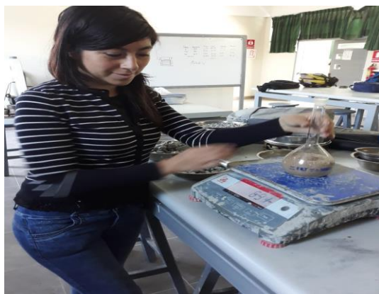
Figura 32: toma de peso de muestra de agregado fino en picnómetro sin burbujas de aire
