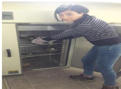
Figura 36: agregado grueso puesto al horno, para luego obtener su peso seco
