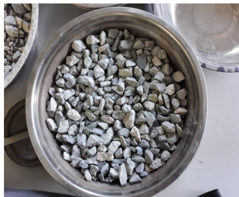
Imagen 2: Peso de muestra del A.G
