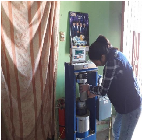
Figura 56: ensayo de compresión de la muestra de concreto
