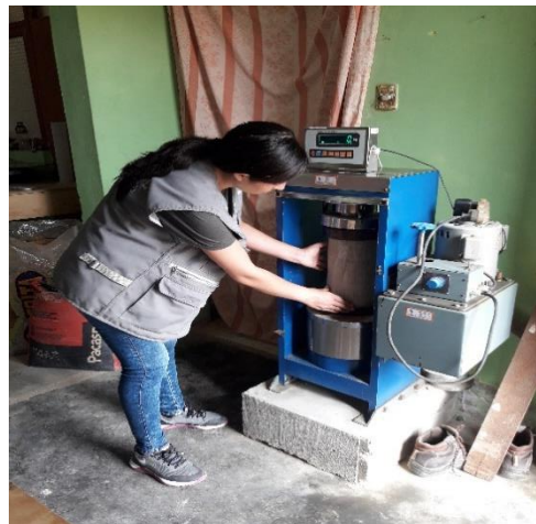
Figura 47: ensayo de compresión de la muestra de concreto
