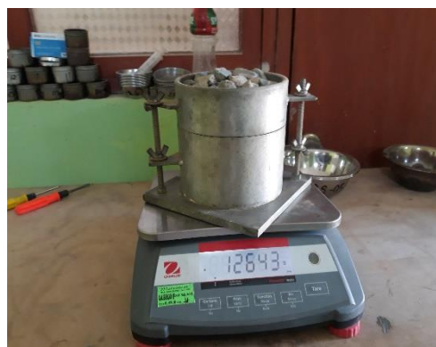
Imagen 11: peso del agregado grueso
