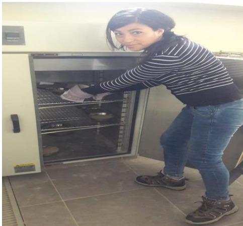
Figura 18: secado de muestra del agregado en el horno
