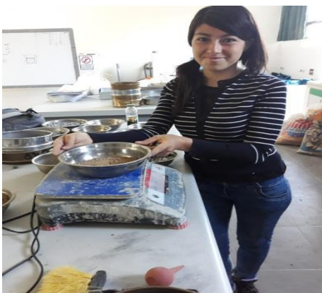
Imagen 1: Peso de la muestra del A.F
