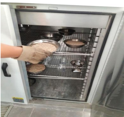
Imagen 3: se mete al horno a una temperatura de 110° por 24 horas
