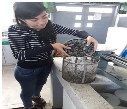
Figura 21: se llena el agregado a la canastilla para ser sumergido
