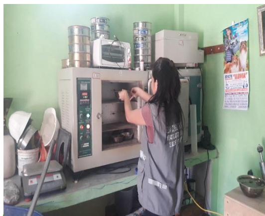
Figura 31: colocación de agregado fino saturado superficialmente seco en el horno para su secado
