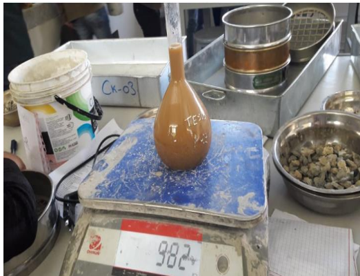
Figura 26: se agitará la fiola para sacar el aire y se procede a pesar
