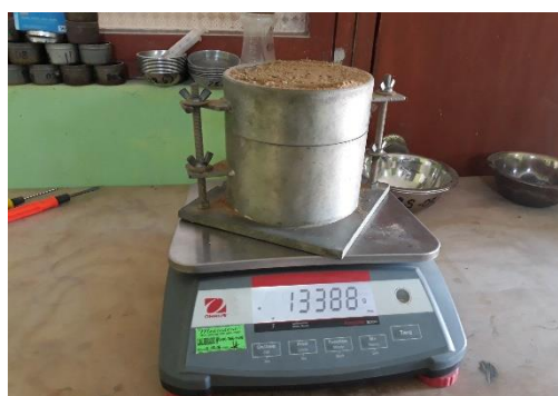
Figura 17: peso del agregado fino
