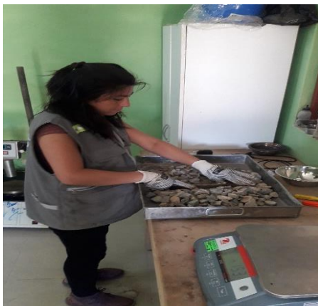
Figura 6: cuarteo del agregado grueso
