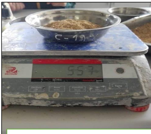
Figura 30: toma de peso de agregado fino saturado superficialmente seco
