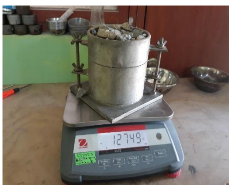
Figura 16: peso del agregado grueso
