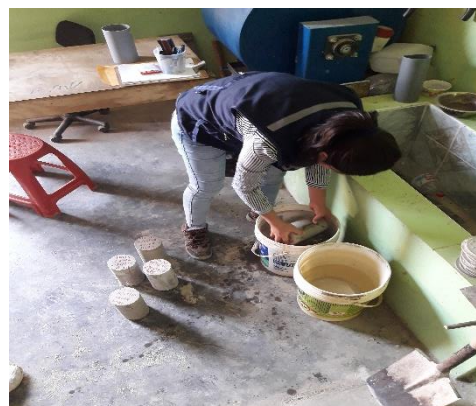
Figura 53: curado de las muestras de concreto
