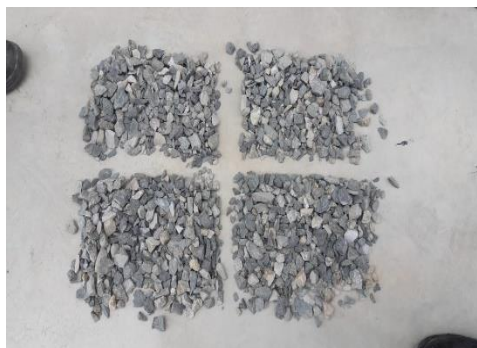
Figura 12: cuarteo de los agregados
