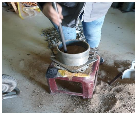
Figura 14: procedimiento de agregado fino compactado
