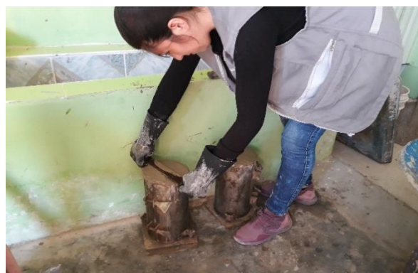
Figura 44: enrasado de muestras de concreto
