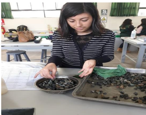
Figura 20: secado del agregado grueso hasta el estado superficialmente seco
