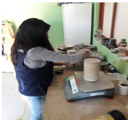
Figura 54: pesando de testigos
