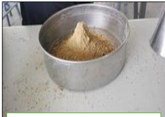
Figura 29: arena en forma cónica terminada en punta después de ensayo con el cono metálico
