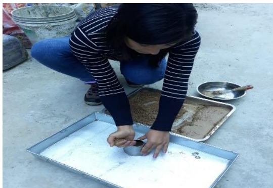
Figura 28: ensayo del cono metálico con el agregado fino
