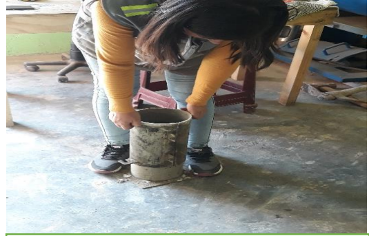
Figura 46: desmoldado de muestras de concreto a las 24 horas después de su vaciado
