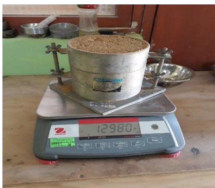
Imagen 10: peso del agregado fino
