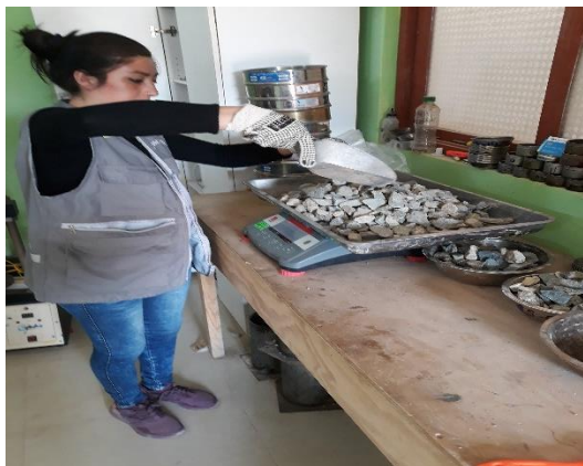
Figura 39: determinación de peso de los agregados de acuerdo al diseño de mezcla
