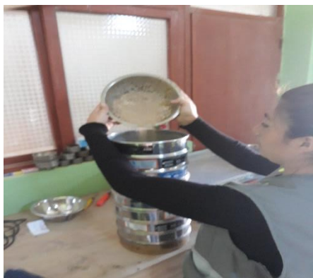
Imagen 5: serie de tamices por las que pasara el agregado fino.
