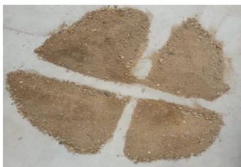
Figura 13: se escogen las diagonales para el llenado
