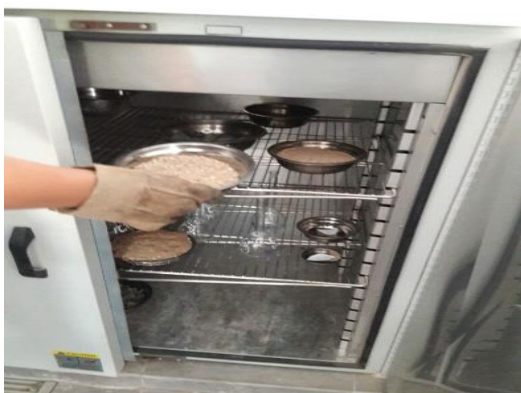
Figura 35: agregado fino puesto al horno por 24 horas, para luego obtener el peso seco
