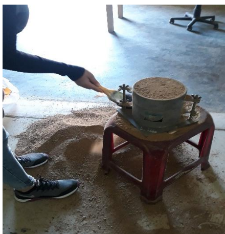
Imagen 8: llenado del molde de forma suelta del grenado fino
