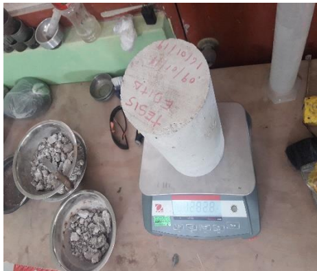
Figura 49: pesando de testigos
