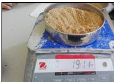
Figura 37: toma de peso seco de muestra de agregado fino para determinar su humedad
