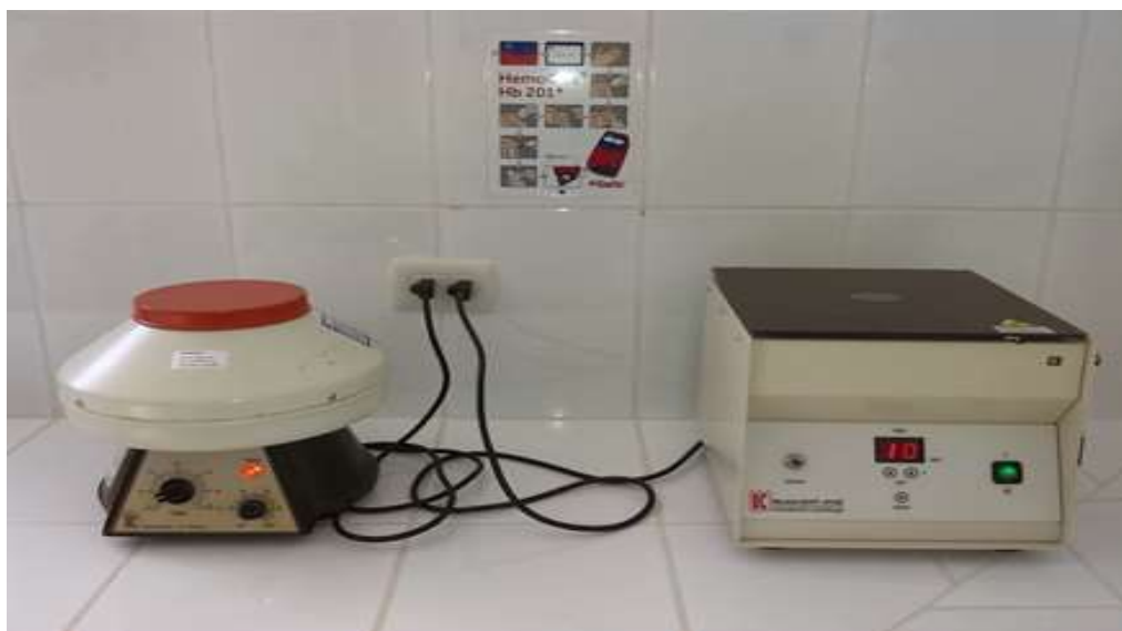
FIG. 07: CENTRIFUGA DE TUBOS PRARA OBTENCION DE SUERO SANGUINEO.
