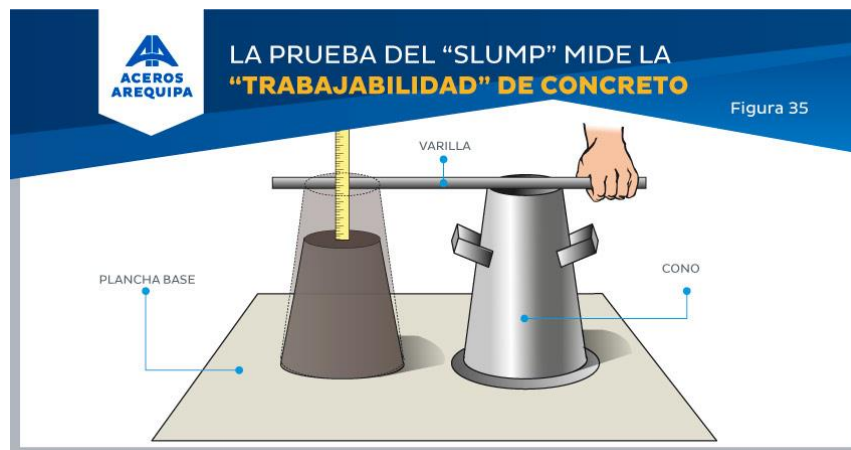
Figura 3: Medida de trabajabilidad del concreto
