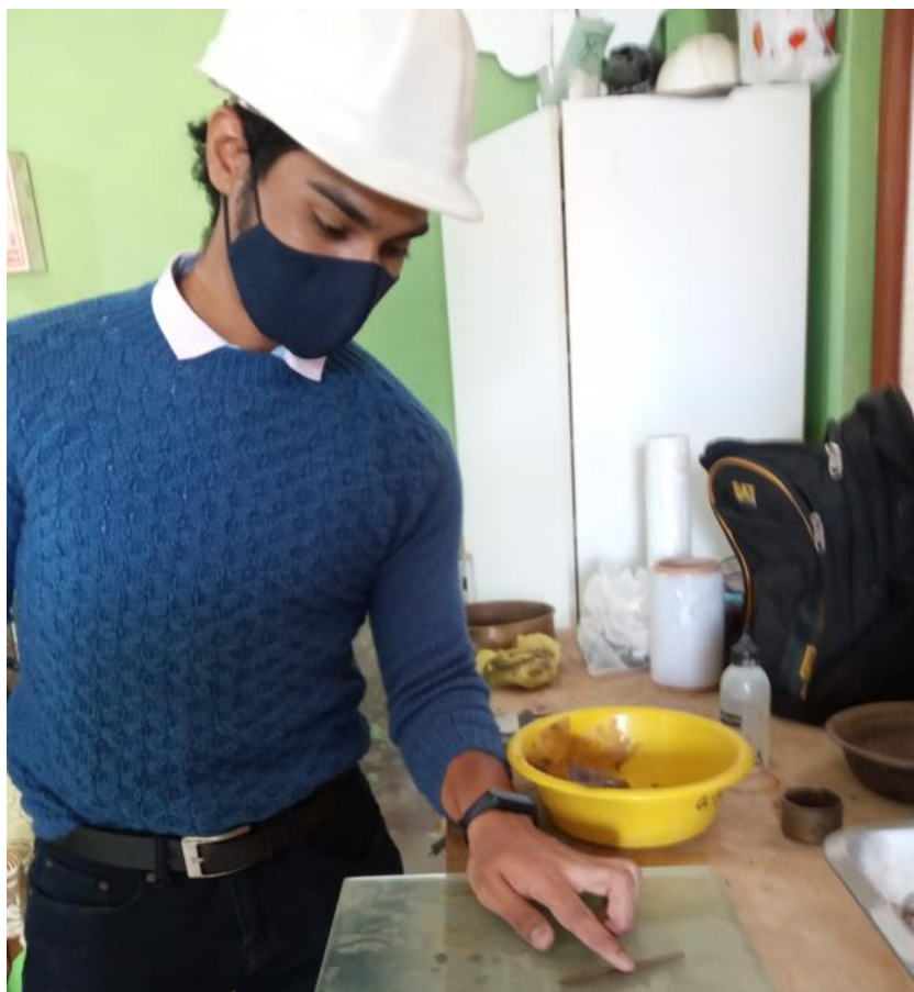
Fotografía 21: Investigador realizando el ensayo de límites de consistencia. Fuente: Propia
