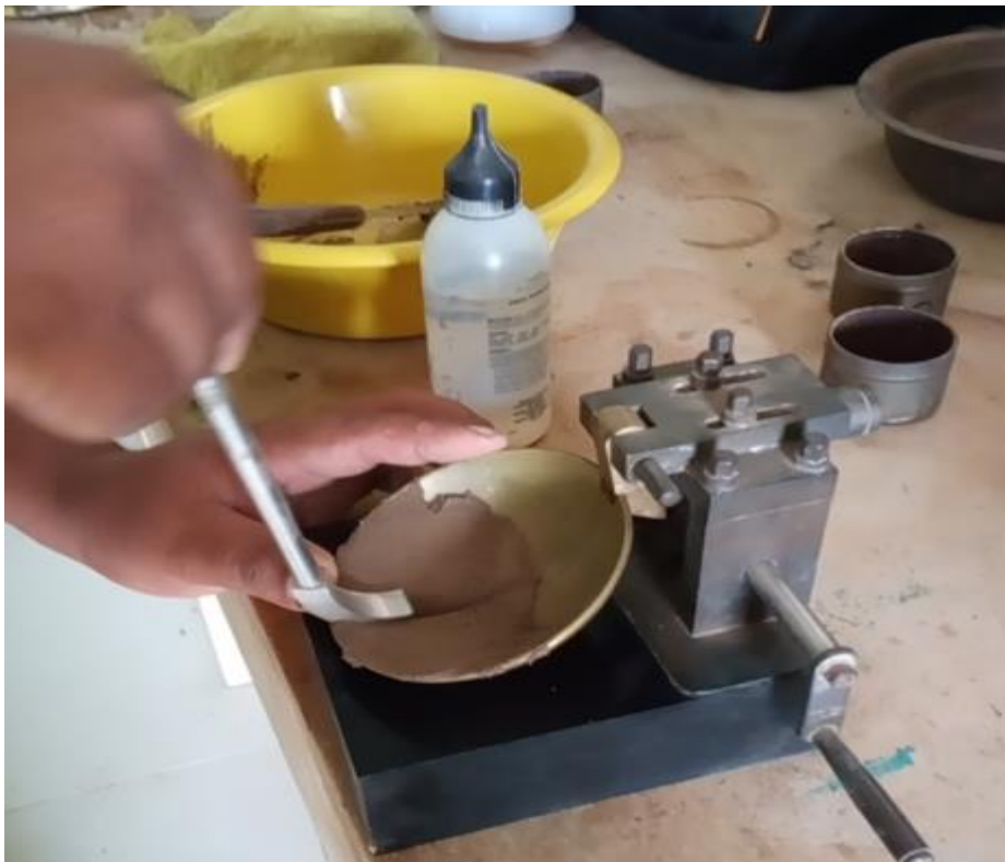
Fotografía 20: Límites de Atterberg a las muestras de suelo. Fuente: Propia, 2021.
