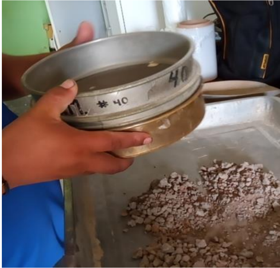
Fotografía 19: Tamizaje de la muestra de suelo. Fuente: Propia, 2021.
