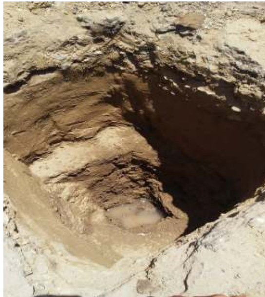
Figura 5: Estratos de la calicata N° 01.
