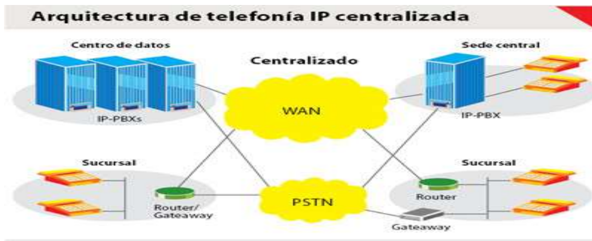
Figura No. 7. Servidores de telefonía IP y Routers
