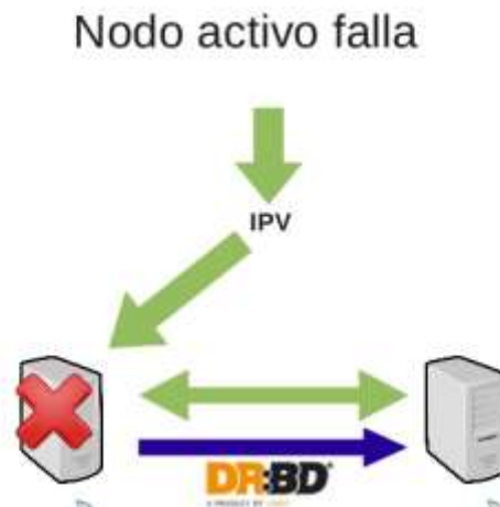
Figura No. 34... FALLA DE NODO ACTIVO
