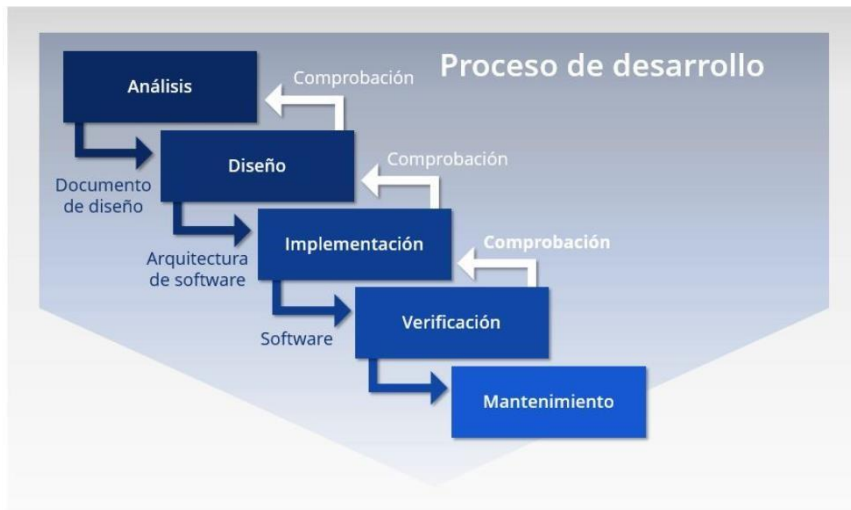
Figura 4. Modelo en cascada simplificado según Royce
