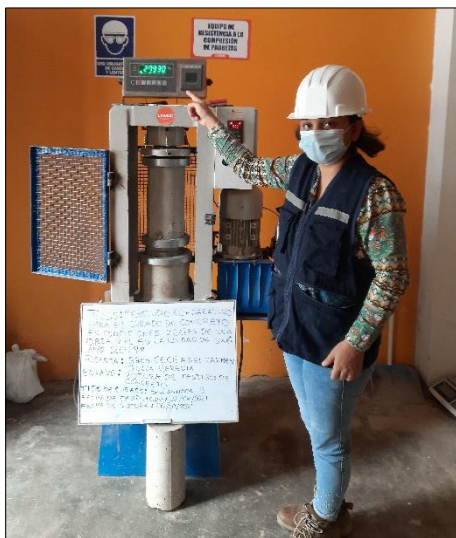
Figura 17. Rotura de testigos de concreto a la edad de 7 días de curado
