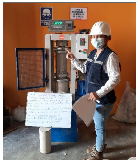
Figura 18. Rotura de testigos de concreto a la edad de 14 días de curado
