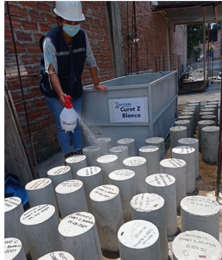
Figura 16. Curado de testigos de concreto con Curet Z Blanco
