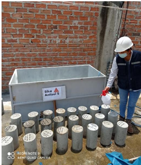
Figura 15. Curado de testigos de concreto con Sika Antisol S
