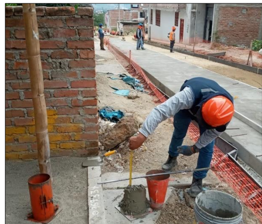
Figura 8. Asentamiento del concreto = 3.5 pulgadas
