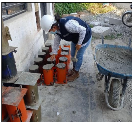
Figura 69. Curado de testigos de concreto
