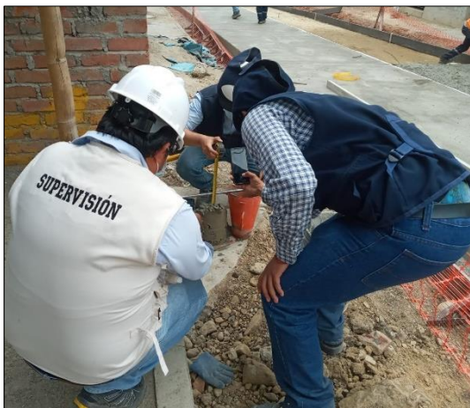
Figura 7. Asentamiento del concreto = 4 pulgadas
