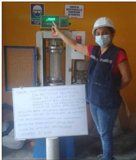
Figura 19. Rotura de testigos de concreto a la edad de 21 días de curado
