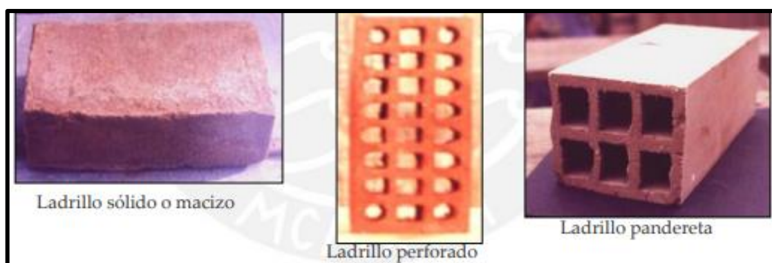
Ilustración 2: Tipos de ladrillo hechos con arcilla
