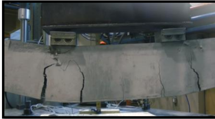
Ilustración 17:Falla por flexión
