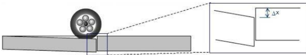
FIG. 7. JUNTA 100% EFECTIVA LA CARGA LA SOPORTA UNA SOLA LOSA
