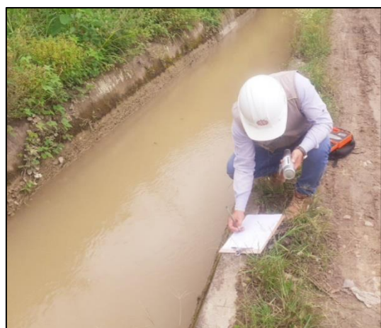
Figura 22. Ensayo de esclerometría en concreto en la UM-12.
