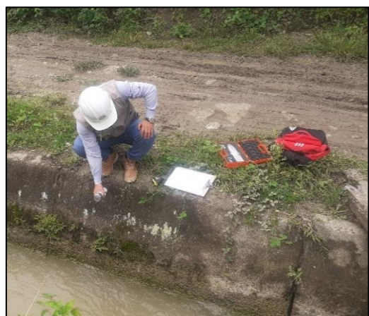
Figura 22. Ensayo de esclerometría en concreto en la UM-12.
