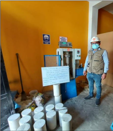
Figura 50. Rotura de testigos de mortero de obra 02, a la edad de 7 días de curado
