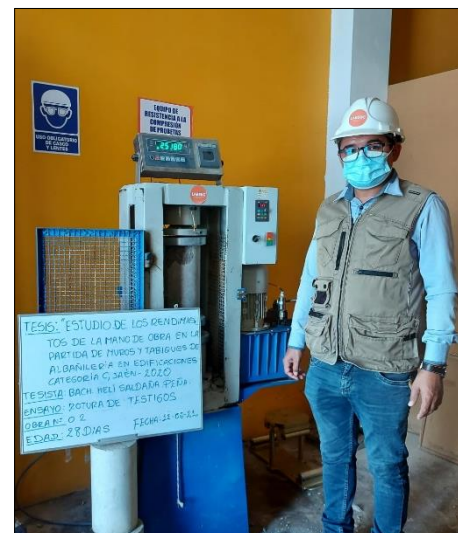
Figura 12. Rotura de testigos de mortero de la obra 02 a los 28 días
