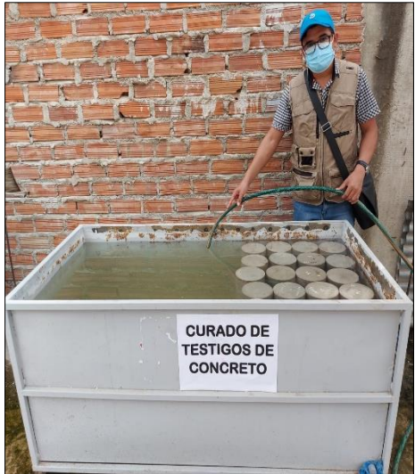
Figura 48. Curado de testigos de mortero con agua potable.
