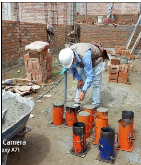
Figura 7. Elaboración de testigos de mortero en obra 02.
