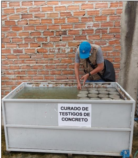
Figura 47. Colocación de testigos de mortero en tanque con agua potable.
