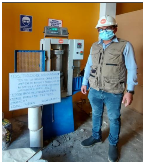
Figura 11. Rotura de testigos de mortero de la obra 01 a los 14 días
