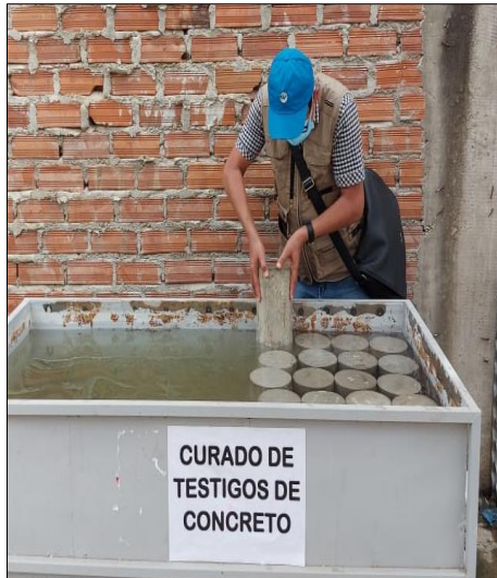
Figura 9. Curado de testigos de mortero de obra 07.
