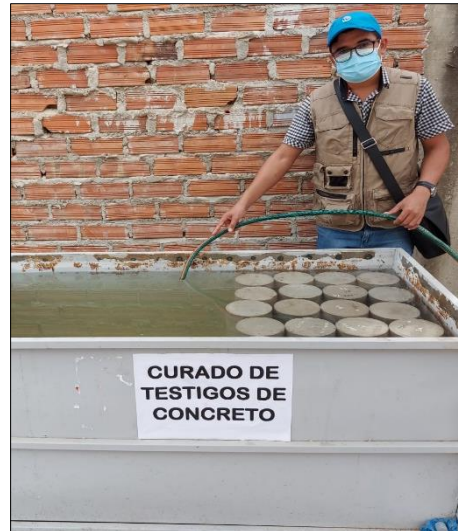
Figura 10. Curado de testigos de mortero de obra 10.
