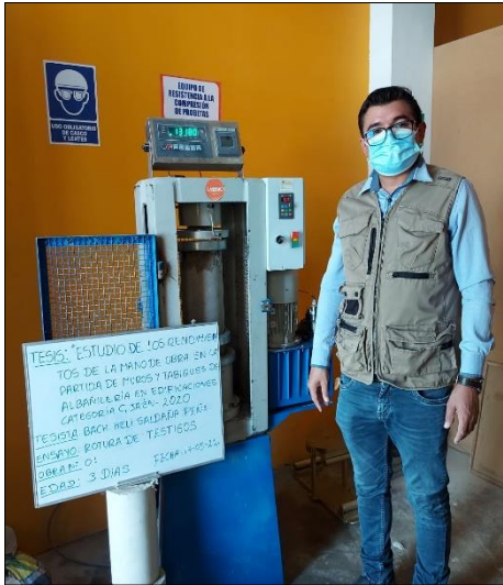
Figura 49. Rotura de testigos de mortero de obra 01, a la edad de 3 días de curado.
