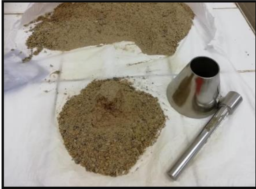
Fotografía 07 - Ensayo de peso específico del agregado
