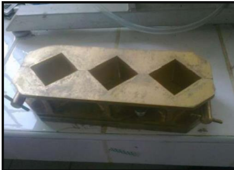
Fotografía 12 - Molde para cubos de mortero
