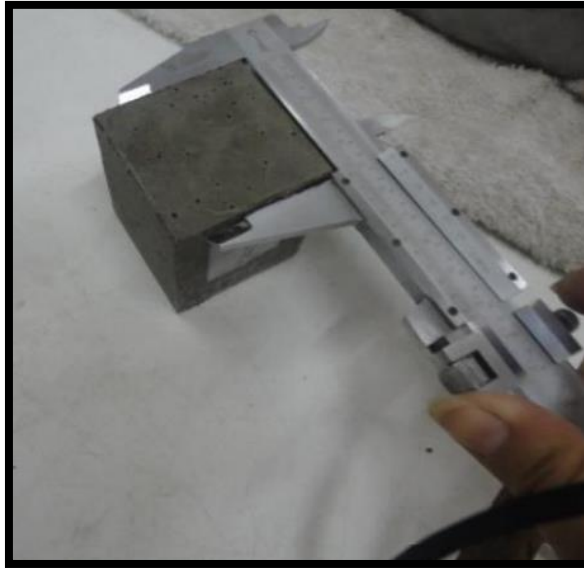
Fotografía 15 – Medición de las aristas de los cubos
