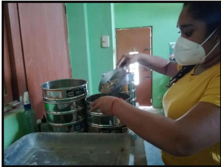
Fotografía 05 - Proceso de tamizado del agregado grueso
