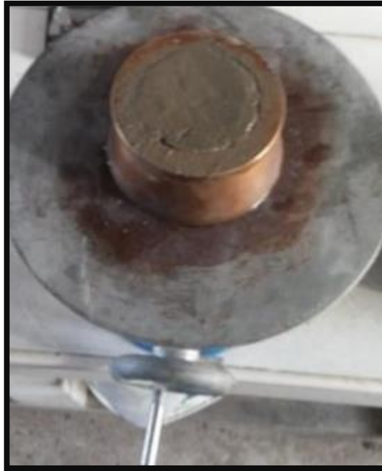
Fotografía 09 - Molde llenado con mortero
