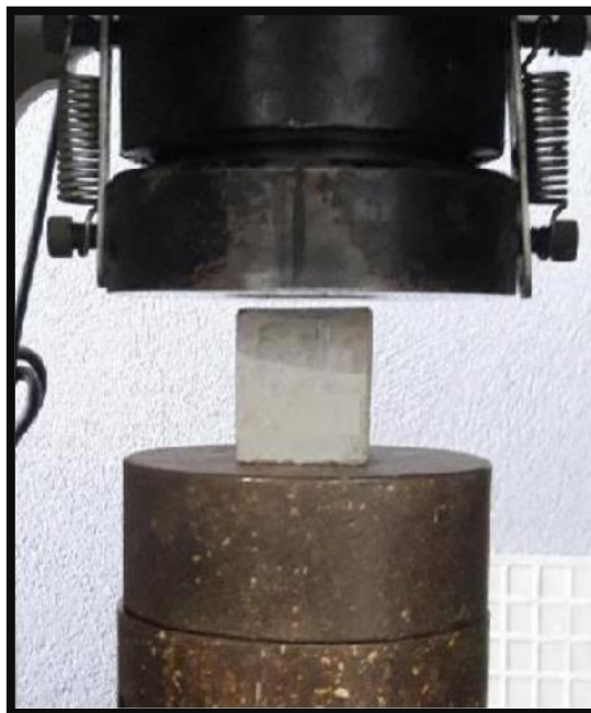
Fotografía 16 - Cubo de mortero en la compresora
