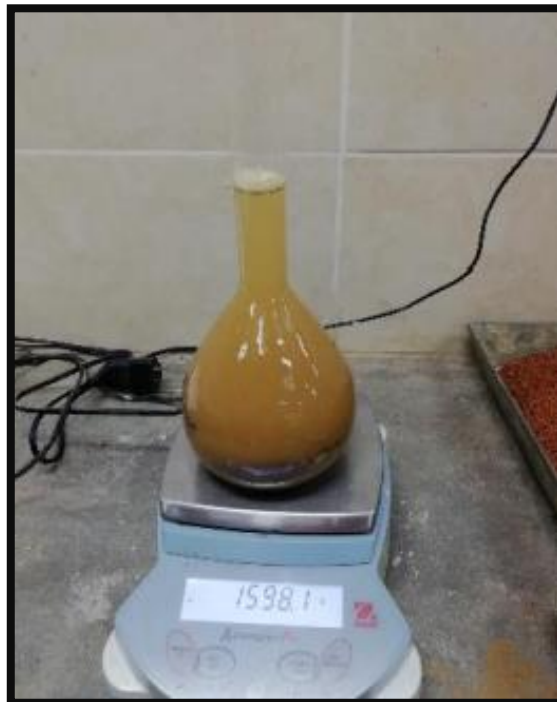
Fotografía 08 - Ensayo de absorción del agregado fino
