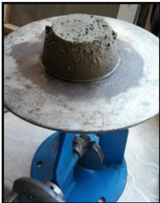
Fotografía 10 - Retiro del molde
