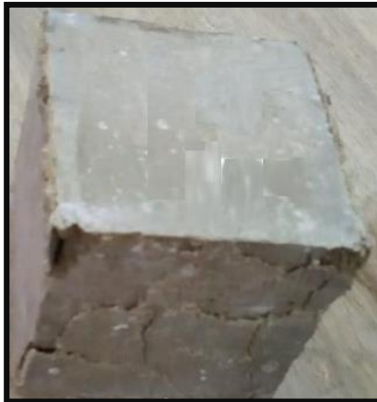
Fotografía 17 - Rotura de cubos de mortero
