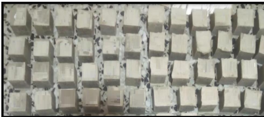
Fotografía 14 - Cubos de mortero desmoldados y rotulados individualmente
