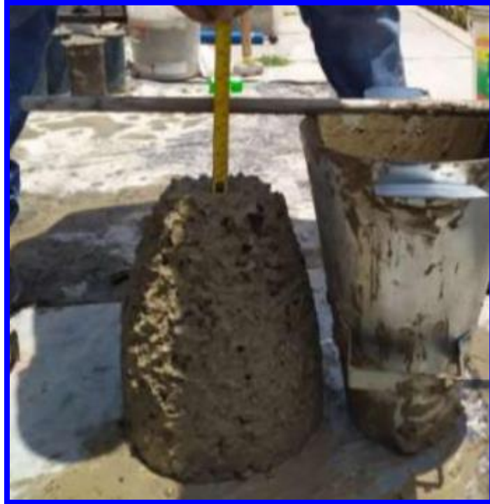
FOTOGRAFIA 09 - DETERMINACION DEL ASENTAMIENTO DEL CONCRETO FAST TRACK (SLUMP)
