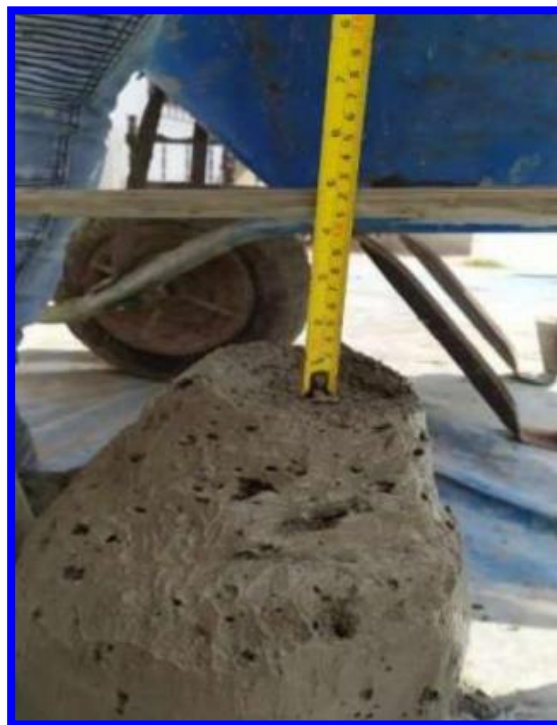
FOTOGRAFIA 08 - ASENTAMIENTO DEL CONCRETO FAST TRACK
