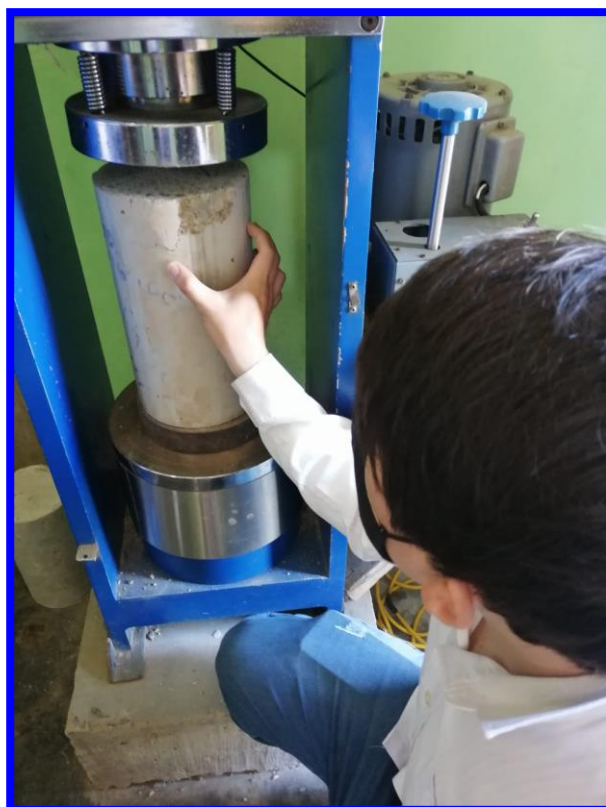
FOTOGRAFÍA 12 - PROCEDIMIENTO PARA ENSAYO DE COMPRESIÓN DEL CONCRETO FAST TRACK
