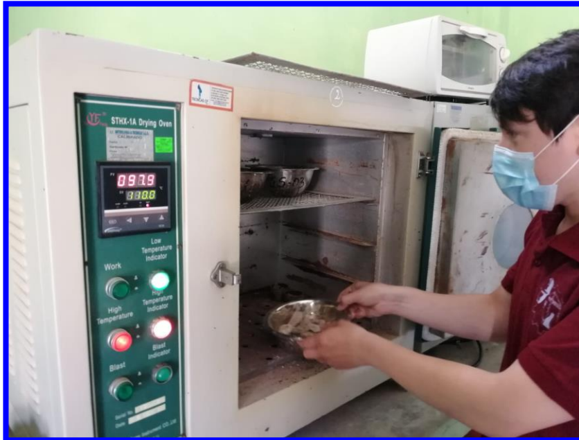
FOTOGRAFÍA 02- COLOCACIÓN DE LOS AGREGADOS EN EL HORNO POR 24 HORAS.
