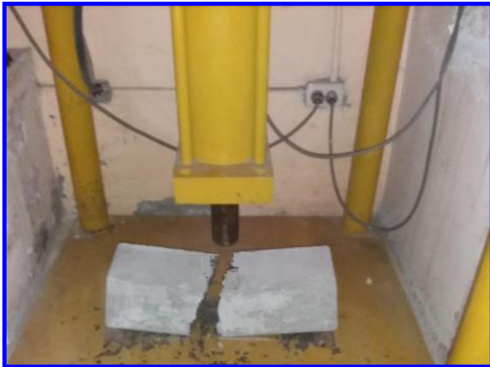
FOTOGRAFÍA 13 - ENSAYO DE FLEXIÓN DEL CONCRETO FAST TRACK
