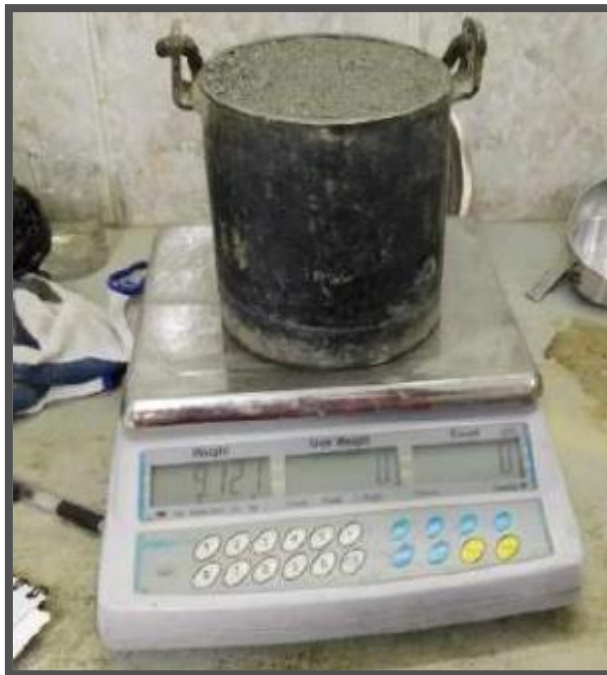
Fotografía 09 - Peso unitario suelto seco de la arena.
