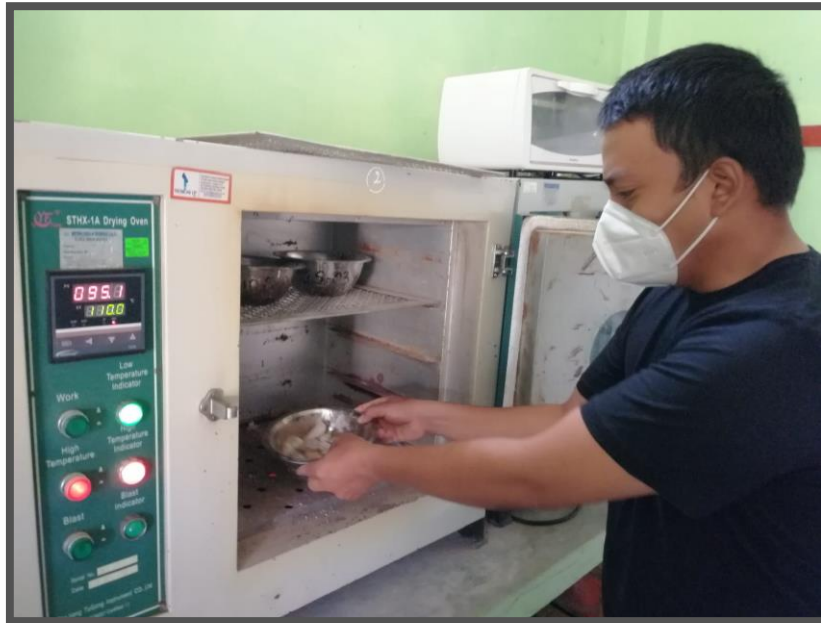
Fotografía 12 - Colocación de los agregados en el horno por 24 horas para el ensayo de contenido de humedad.
