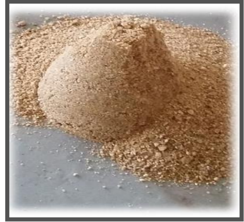
Fotografía 14 - Determinación del peso específico y absorción del agregado fino
