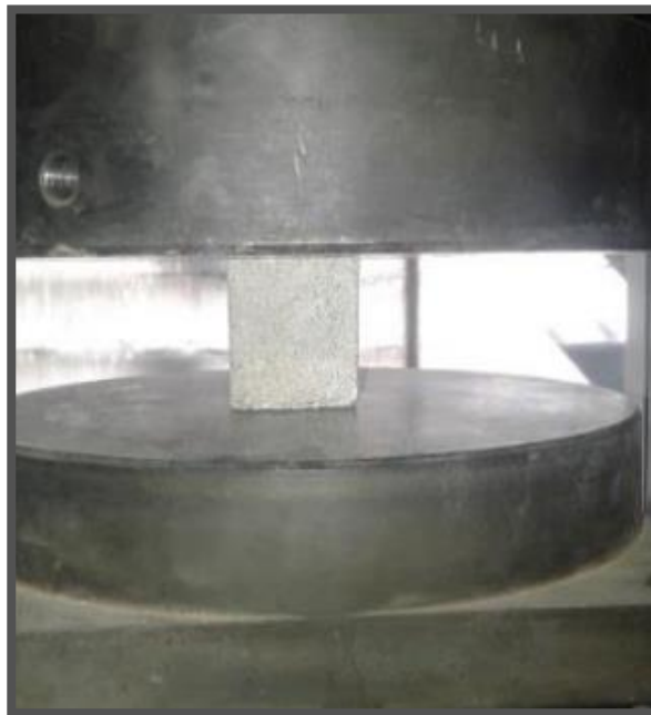
Fotografía 21 – Ensayo a compresión de testigos de mortero.
