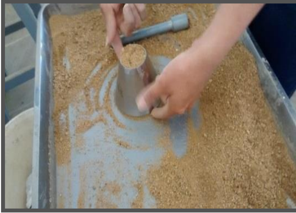
Fotografía 14 - Determinación del peso específico y absorción del agregado fino
