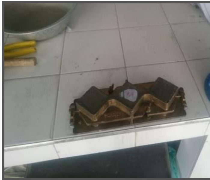
Fotografía 18 – Molde para cubos de mortero.
