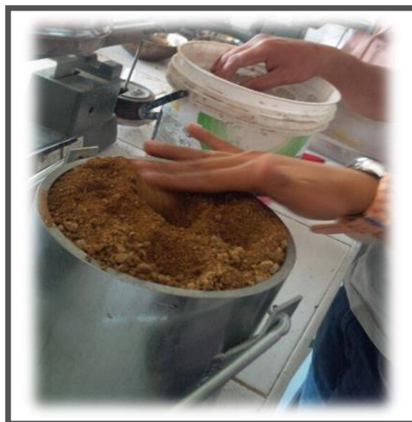
Fotografía 11 - Proceso del ensayo de Peso Unitario Suelto y Compactado del agregado fino
