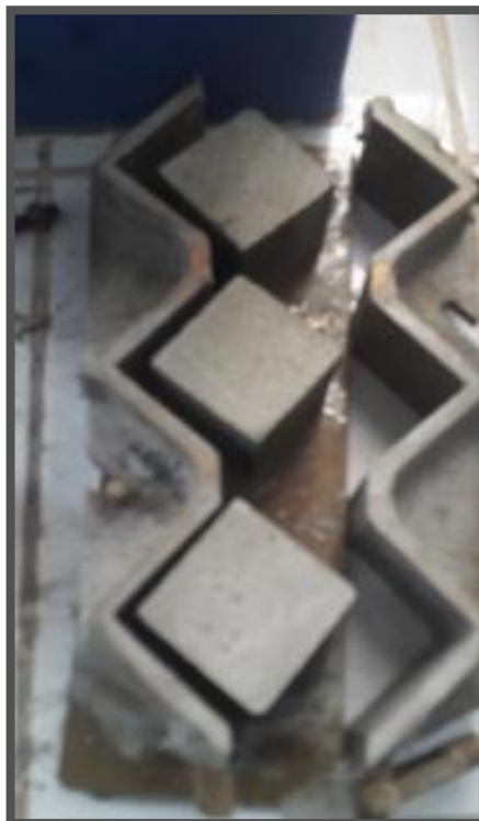
Fotografía 19 – Desmoldado de cubos de mortero.
