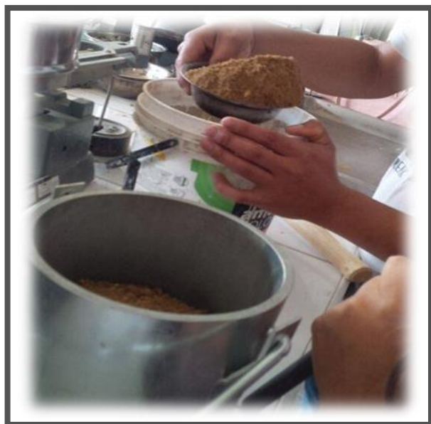
Fotografía 11 - Proceso del ensayo de Peso Unitario Suelto y Compactado del agregado fino
