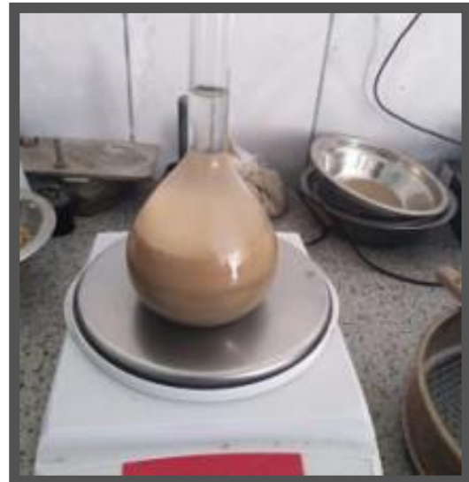
Fotografía 15 - Determinación del peso específico y absorción del agregado fino
