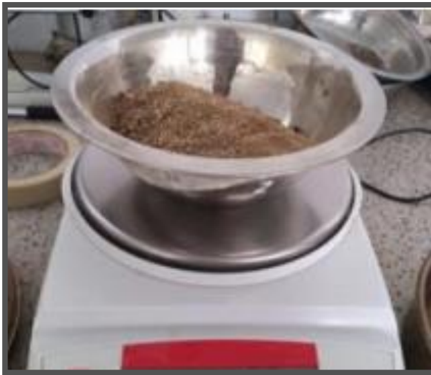
Fotografía 15 - Determinación del peso específico y absorción del agregado fino
