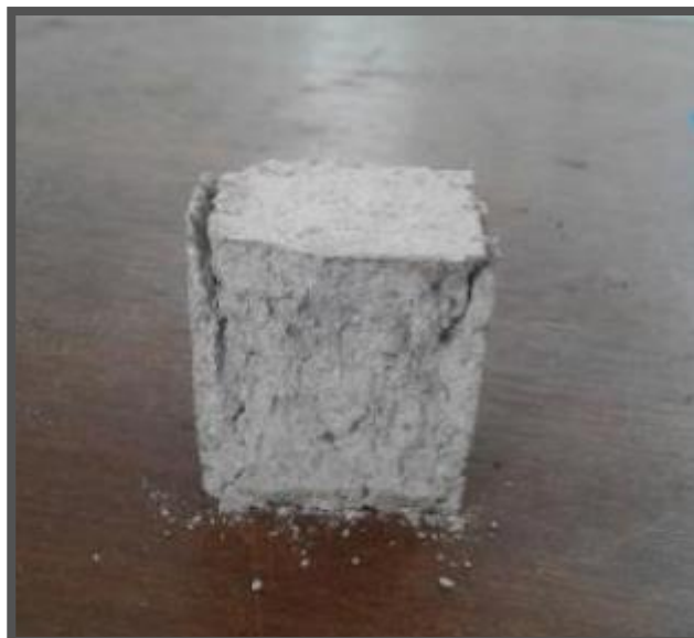
Fotografía 22 – Falla presentada de testigos ensayados a compresión
