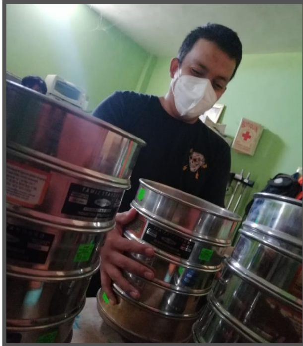
Fotografía 07 - Tamices para el ensayo de granulometría del agregado fino.
