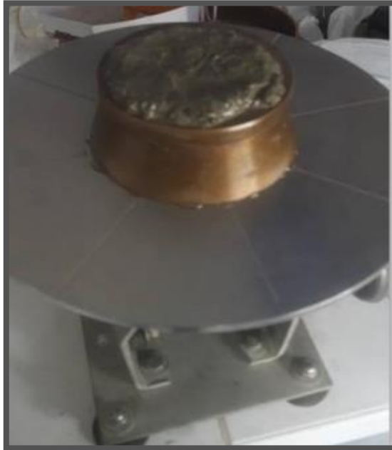
Fotografía 16 - Molde llenado con mortero
