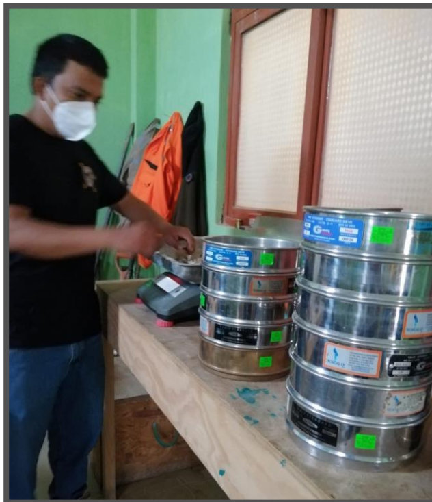
Fotografía 08 - Procedimiento para granulometría
