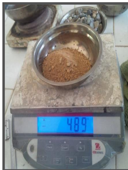
Fotografía 13 – Resultados del Ensayo de contenido de humedad del agregado fino.
