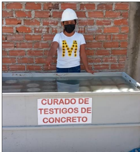
Figura 9. Curado de testigos de concreto en agua potable
