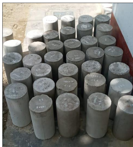
Figura 8. Especímenes cilíndricos de concreto desmoldados
