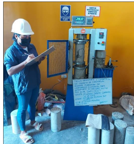
Figura 10. Rotura de especímenes de concreto a la edad de 21 días de obra 04.
