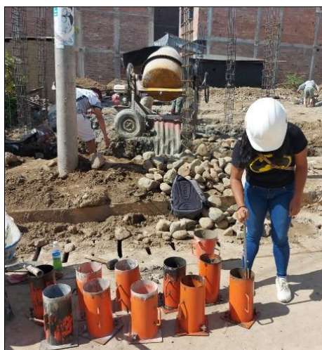
Figura 7. Elaboración de especímenes cilíndricos de concreto en obra
