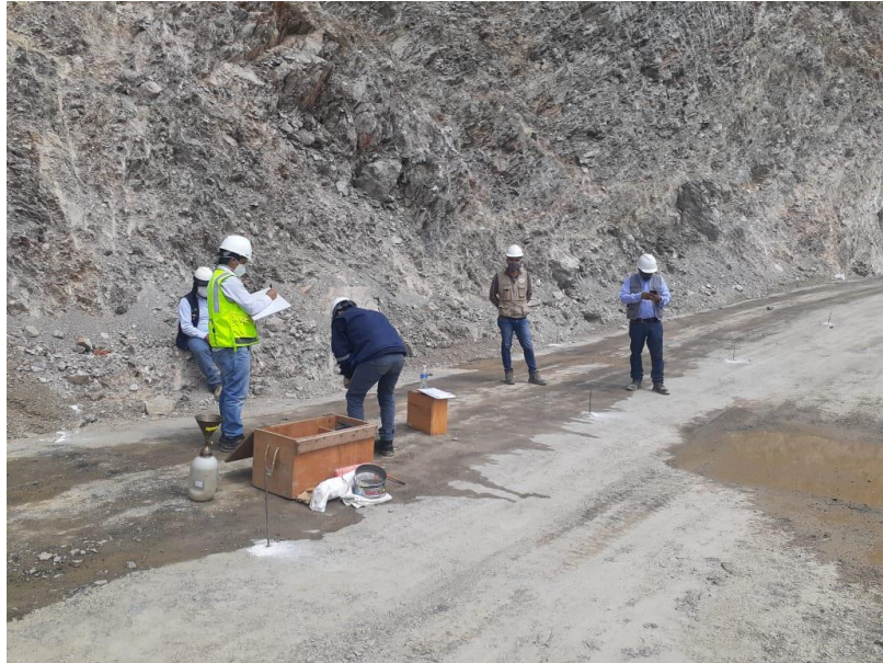
Control de mecánica de suelos, siguiendo protocolos establecidos.
