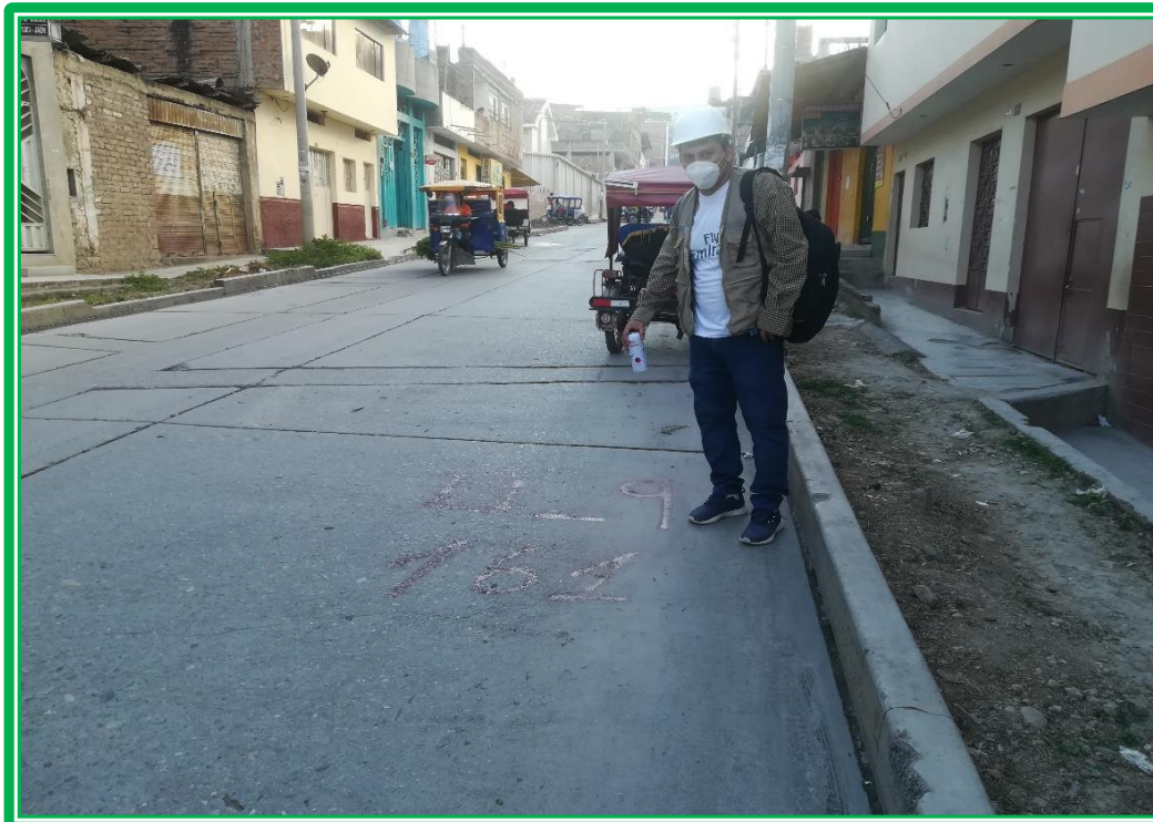
Foto 31. Paño 161, en la U-09, en Progresiva 0+422.45 Km, en la Cuadra N° 13, Marcación del Unidad de Muestra, para su respectivo identificación de fallas.
