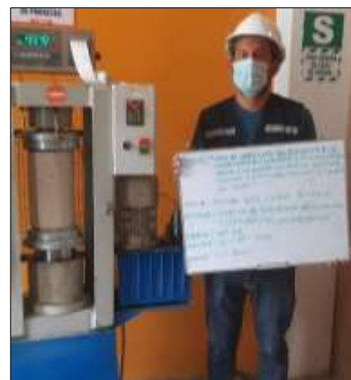
Figura 89. Rotura de testigos a los 28 días
