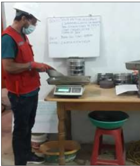
Figura 21. Proceso de pesado del agregado fino
