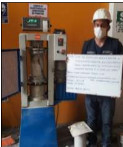
Figura 112. Rotura de testigos a los 21 días
