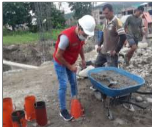
Figura 123. Elaboración de testigos de concreto
