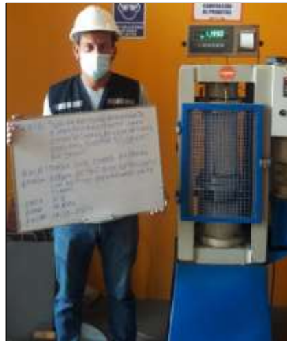
Figura 77. Rotura de testigos a los 14 días
