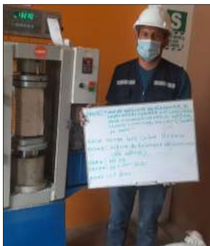
Figura 94. Rotura de testigos a los 3 días
