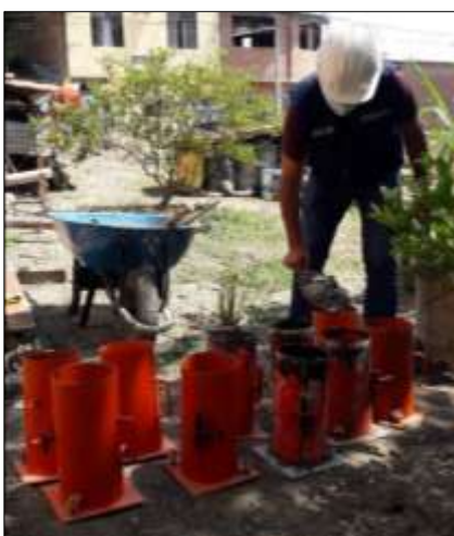
Figura 70. Elaboración de testigos de concreto
