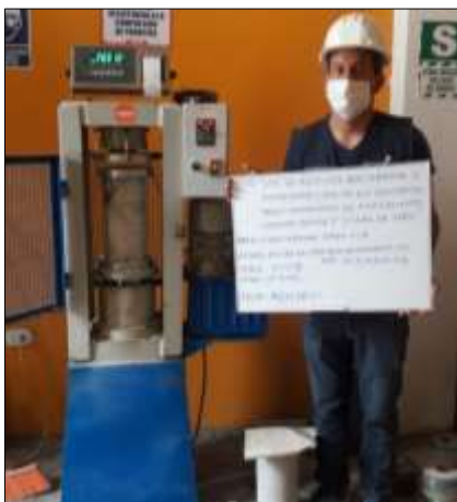
Figura 118. Rotura de testigos a los 21 días
