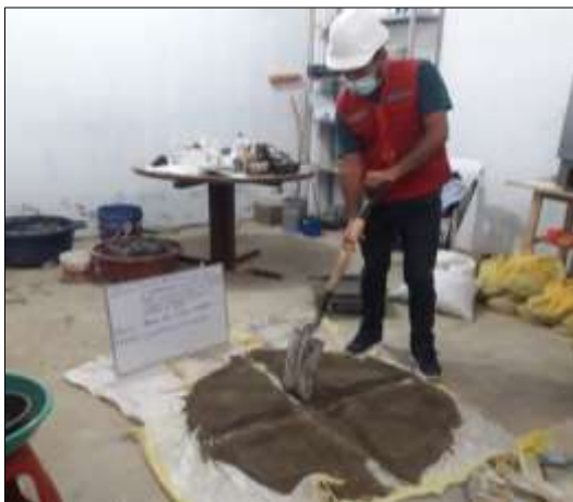
Figura 17. Cuarteo de agregado fino
