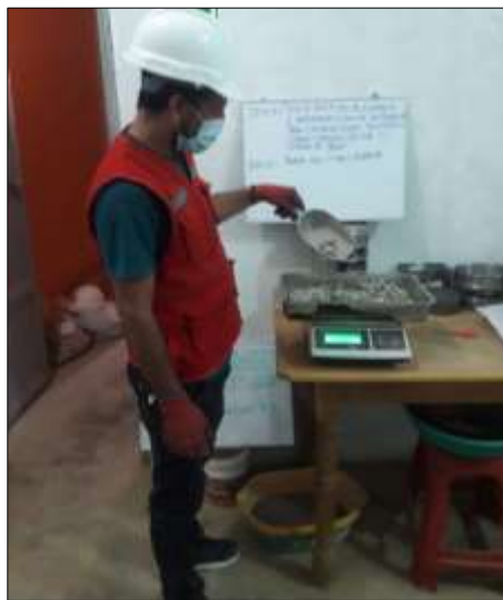
Figura 22. Proceso de pesado del agregado grueso
