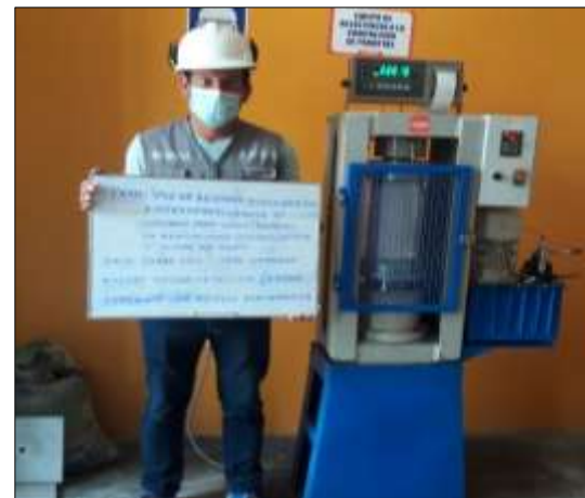
Figura 16. Rotura de testigos de concreto de obra N° 01
