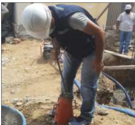
Figura 88. Ensayo de asentamiento
