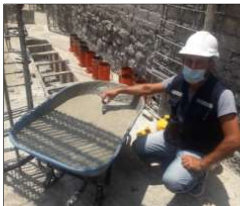
Figura 93. Elaboración de testigos de concreto
