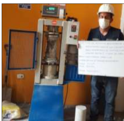
Figura 106. Rotura de testigos a los 28 días
