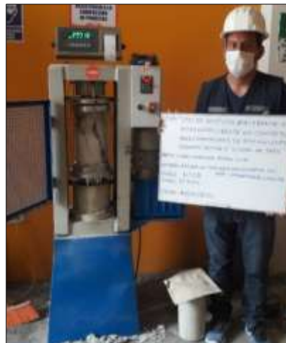
Figura 113. Rotura de testigos a los 21 días
