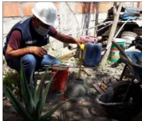
Figura 69. Asentamiento del concreto
