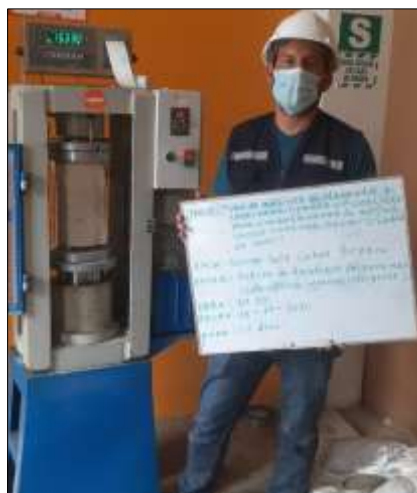
Figura 95. Rotura de testigos a los 3 días
