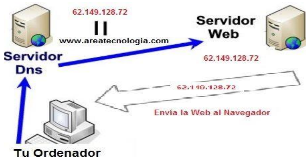
Ilustración 11. Funcionamiento del servicio DNS
